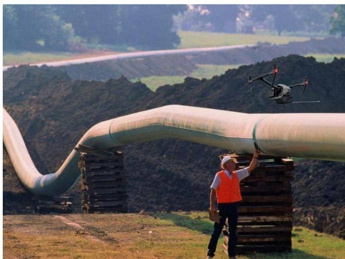
Detalhe da solução DR2000 do fabricante canadiano Scentroid a realizar uma detecção de fugas ao longo de um oleoduto
